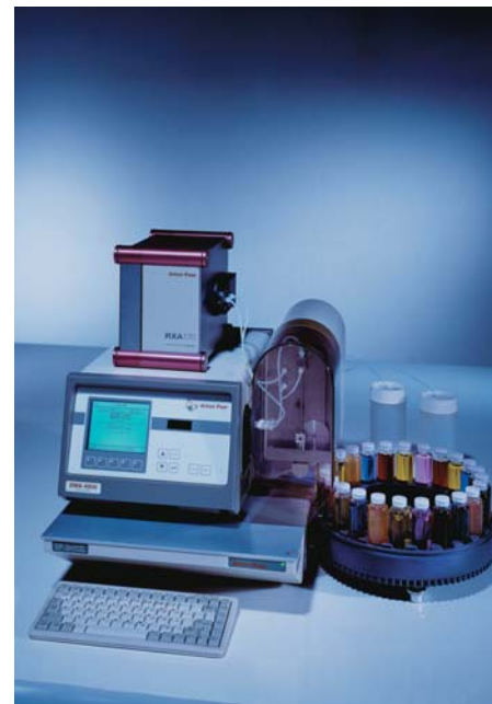
2. ábra: DMA készülékcsalád és az RXA refraktométer készülék együttes használata
